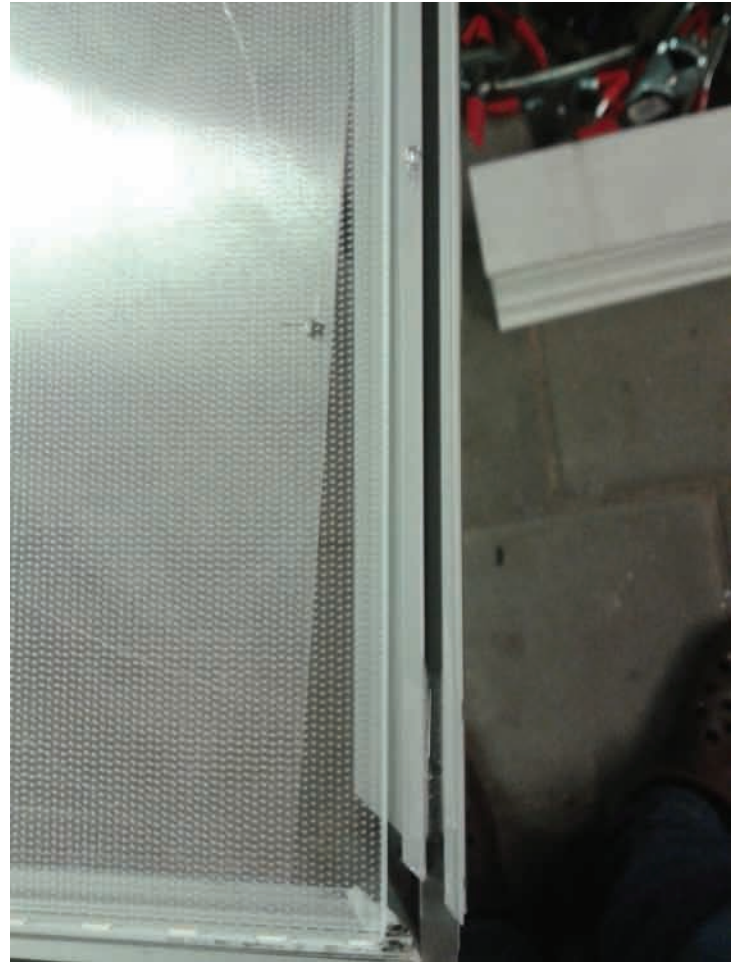
2. Krassen op de lichtplaat. Boven op de lijst is een gedwongen hoekverbinding (zie 3 en 4).
