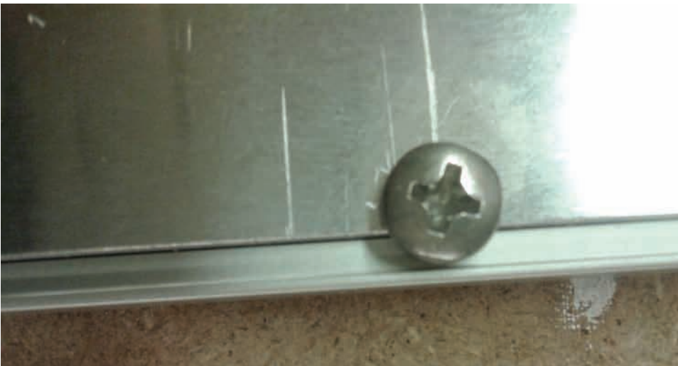
3 (links) en 4. De schroefgaten zitten op de verkeerde plaats, tegen de rand van de alu achterkant, zodat de schroeven geforceerd zijn ingedraaid.
