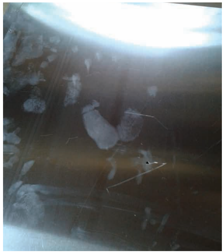
6. Afdrukken van grote, vette hand. Deze komen ook tussen de platen voor en zijn niet weg te poetsen.
