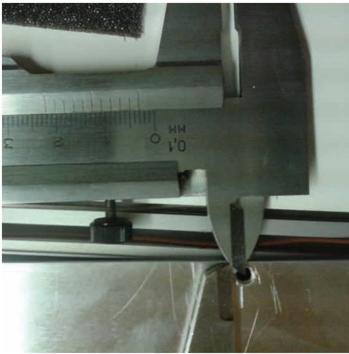
5. Afwijking van juiste boorplaats. Dat is bij andere gaten ook get geval zodat de afwijking meer dan 6 mm kan zijn!
