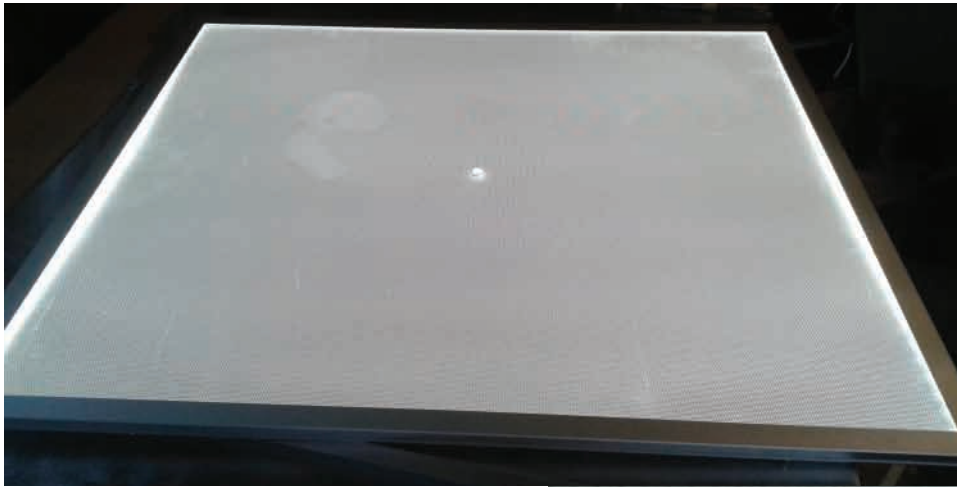
7. Vochtplekken tussen de verschillende platen in de panelen, en verticale krassen met vochtsporen vanaf de onder- en bovenrand, met meer krassen en vlekken.
