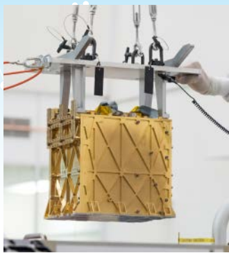
Hierboven: de MOXIE, die zuurstof haalt uit de Marsatmosfeer.
